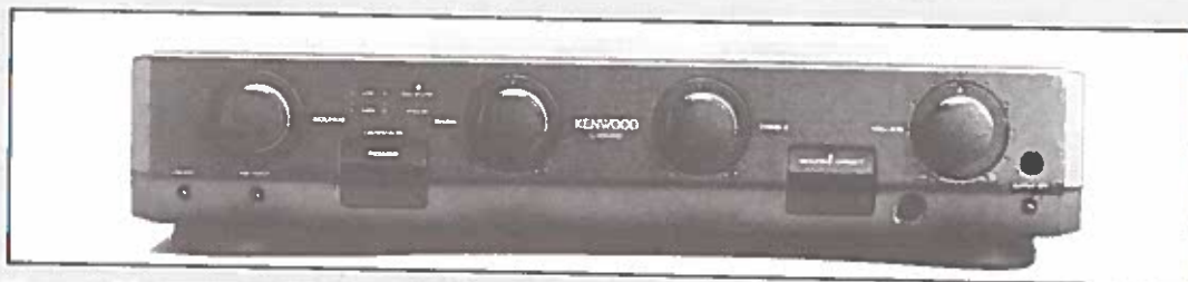
Kenwood L-1000C med balanceret signaltransmission fra ind- til udgang.
