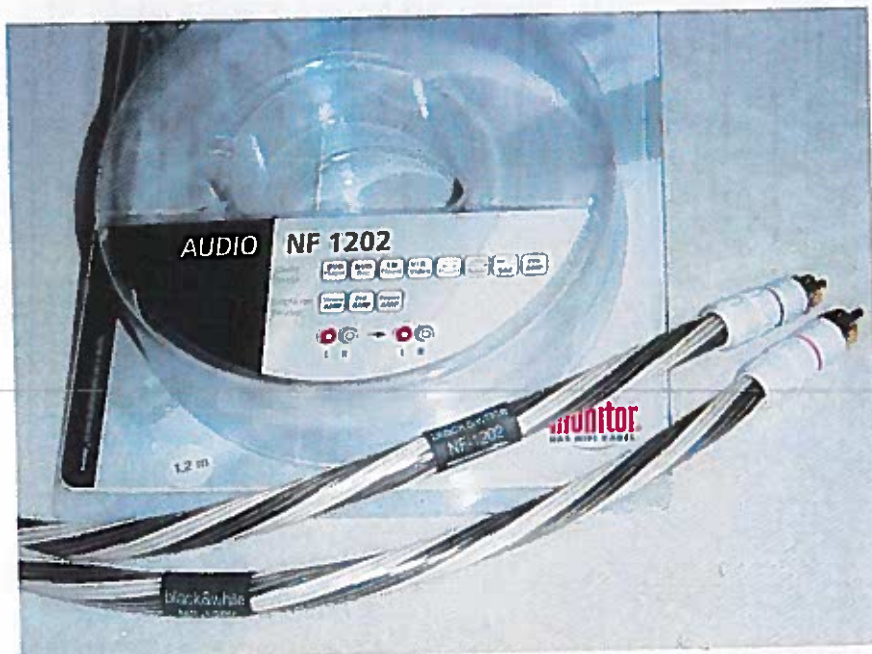
Topkablet NF-1202 fra Monitor er kraftigt og indeholder 2 x 6 solidcore ledere med polyethylen isolering og solide gedigne stik af god kvalitet.
