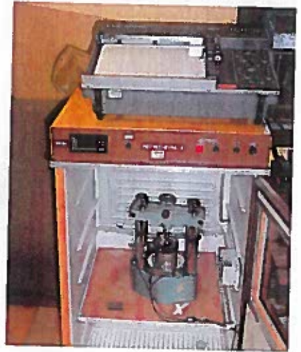
En af Per Windfeldts konstruktioner er denne ovn, hvor man kan bage gummi under tryk og måle forskellige kritiske egenskaber ved materialet.
