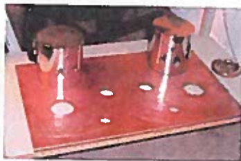
På et tidspunkt skal Renes monstrum pakkes pænere ind. Denne 10 mm tykke kobberplade vil udgøre toppen. De to runde "tårne" skal rumme udgangstrafoerne. Det lille messingjul til højre skal anvendes til volumekontrollen.
